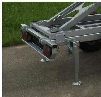
**Der Anhänger darf mit den Stützen nicht angehoben werden.**
