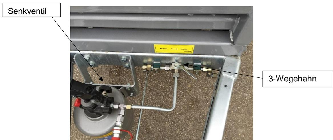
Die Kipperbrücke kann entweder mit der Handpumpe hochgepumpt oder durch die Hydraulikanlage des Zugfahrzeuges angehoben werden. Es ist darauf zu achten, dass genügend Freiraum hinter dem Anhänger ist. Da die Kipperbrücke beim Anheben ca. 200 mm vertikal nach hinten geschoben wird.
